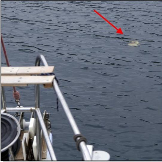
La ligne de l'orin doit être suffisamment résistante pour désengager l'ancre, réputée coincée dans le fond. Pour la désengager, il faut donc utiliser **une ligne aussi résistante qu'une drisse** (de GV, par exemple) et assez grosse pour pouvoir la frapper sur un winch *self tailing*, si nécessaire.
