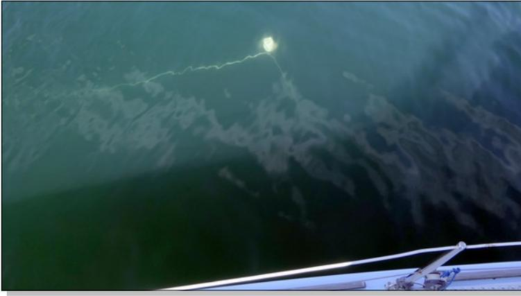
Sur la photo, on voit très bien les deux parties de l'orin, séparées par le flotteur. L'une part vers la chaîne avec une faible pente (à gauche). La partie accrochée à l'ancre est presque verticale (à droite).
